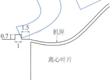
图 2 第一套处理机匣 (单位:mm) Fig.2 First treated casing (Unit:mm)
